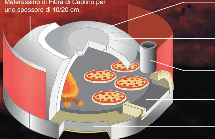
Stuccatura di giunzione tra gli spicchi della calotta, ed il piano di cottura e gli spicchi, in cemento plastico refrattario ad alta tenuta.
