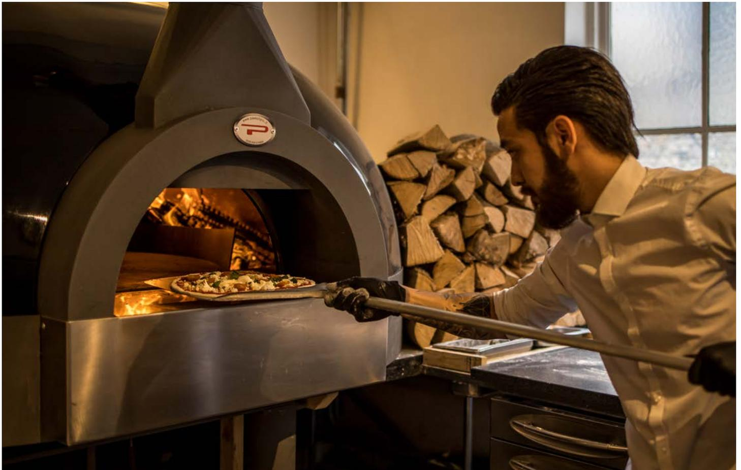
*A través de la instalación del quemador Drago Avanzini cualquier horno Pavese a leña puede ser alimentado también por gas.*
